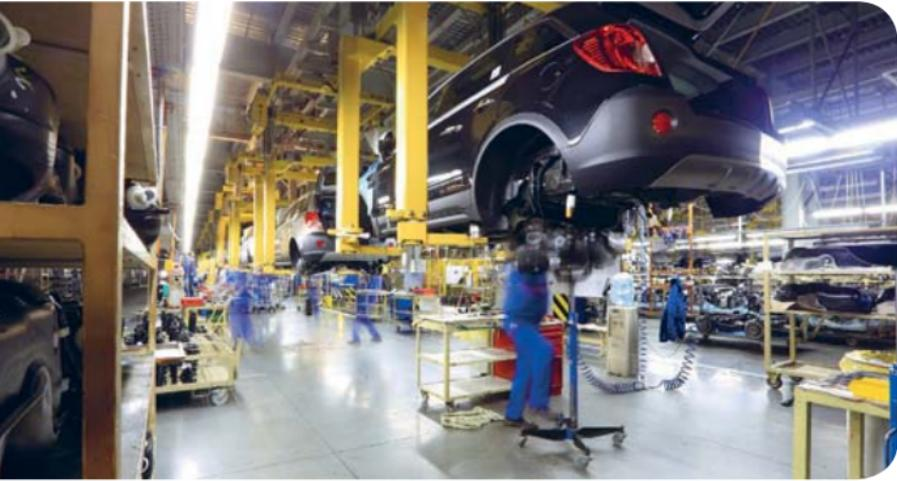
↑ Haltevorrichtungen können so programmiert werden, dass die Montagearbeiten in einer ergonomisch günstigen Körperhaltung durchgeführt werden können.
