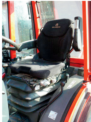
Ein Fahrersitz mit pneumatischer Dämpfung fängt Erschütterungen ab.
